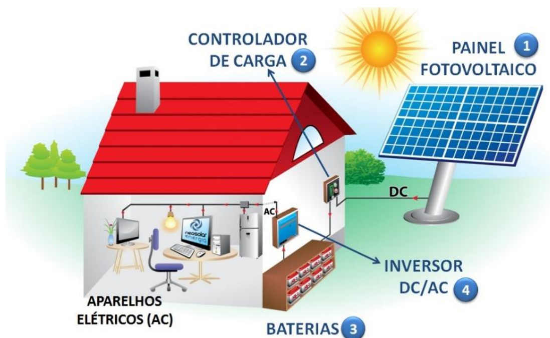
Figura 2 - Componentes básicos de um SFI com armazenamento Fonte: SUNRIO, 2017.
