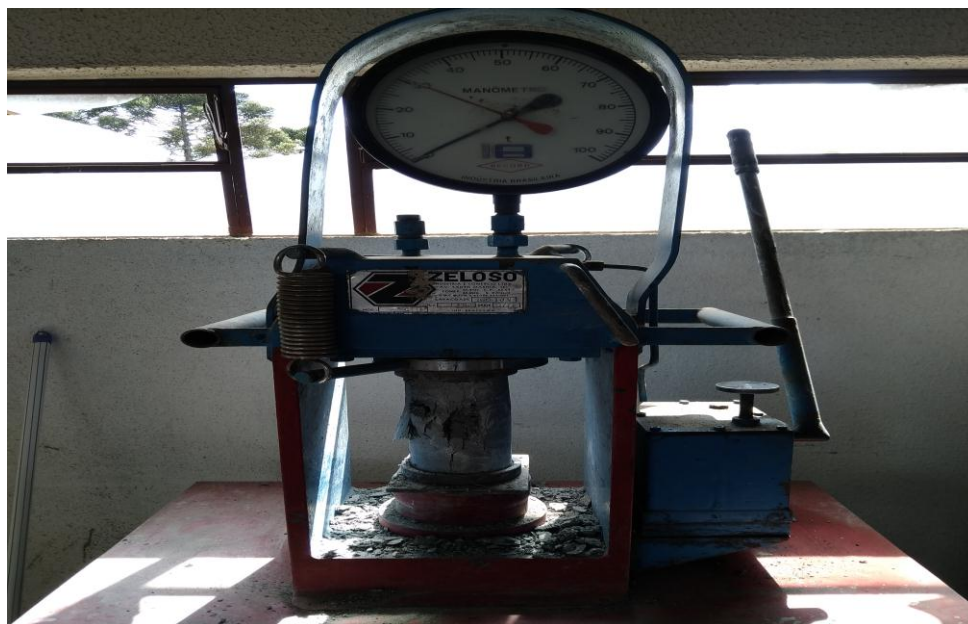
Figura 16: Prensa hidráulica instalada na empresa para testes de compressão Fonte: Autoria Própria (2018).
