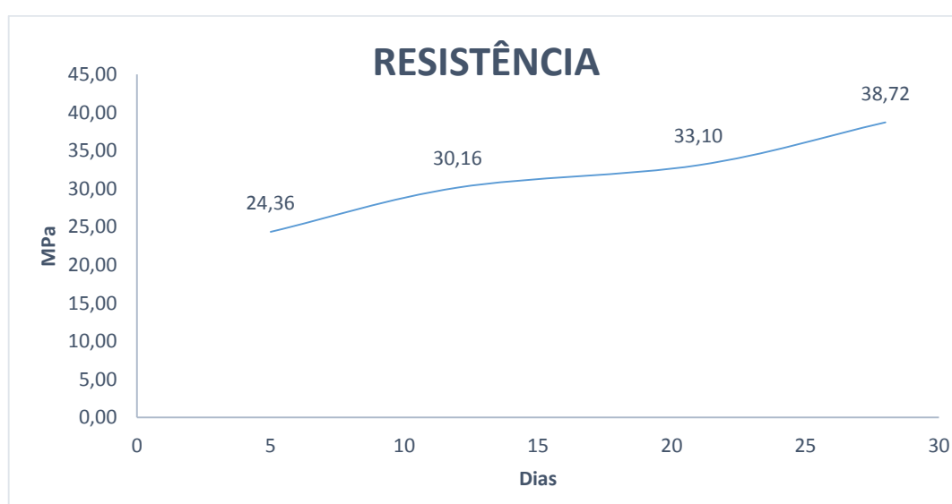
Figura 30: Curva da resistência a compressão em relação a idade de rompimento – décima quarta coleta. Fonte: Autoria Própria (2018).
