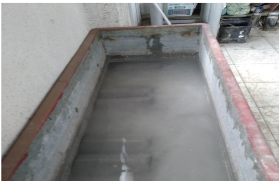
Figura 15: Recipiente para cura Fonte: Autorial Própria (2018).
