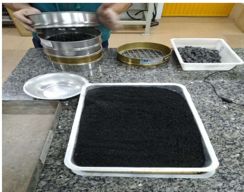
Figura 4: Utilização das peneiras específicas Fonte: Autoria Própria (2018).
