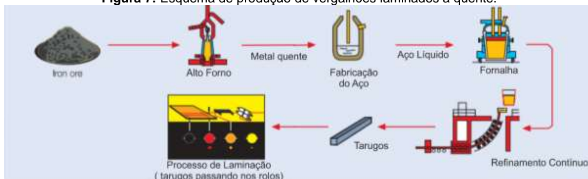
Figura 7: Esquema de produção de vergalhões laminados a quente.
