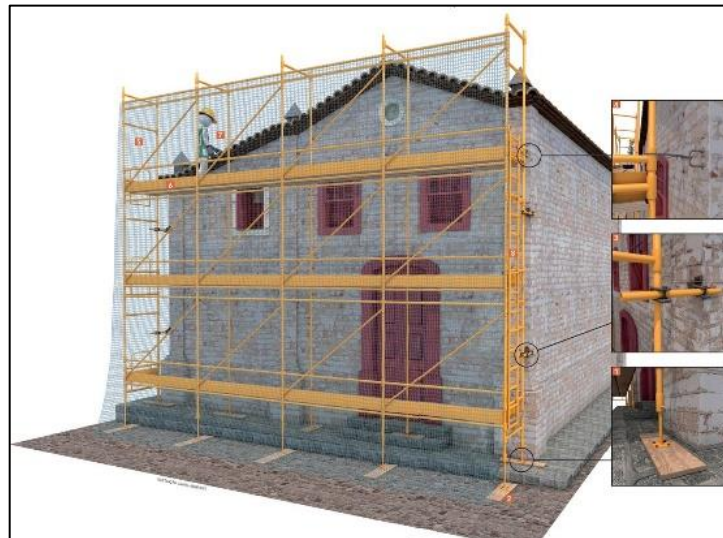
Figura 4 – Andaime fachadeiro Fonte: Giribola, 2014, p.1.
