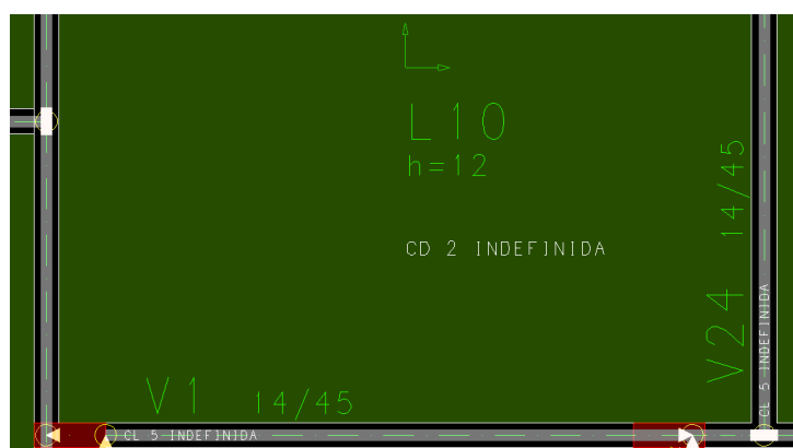
Figura 17 – Cargas indefinidas em lajes e vigas originadas na importação Fonte: Autoria própria (2018).
