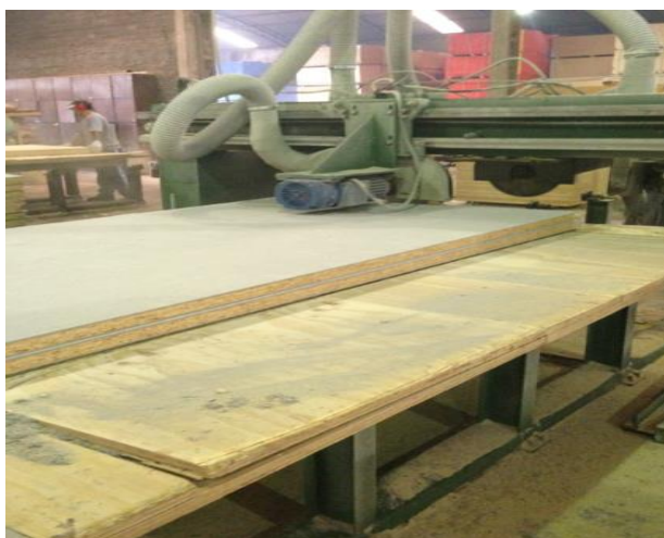
Figura 22 - Placa OSB-cimentícia entrando na esquadrejadeira. Fonte: Acervo do autor (2014)
