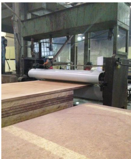
Figura 19 - Chapa OSB recebendo camada de resina fenólica. Fonte: Acervo do autor (2014)
