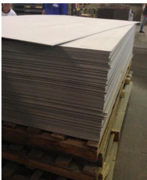
Figura 18 - Armazenamento das placas cimentícias.
