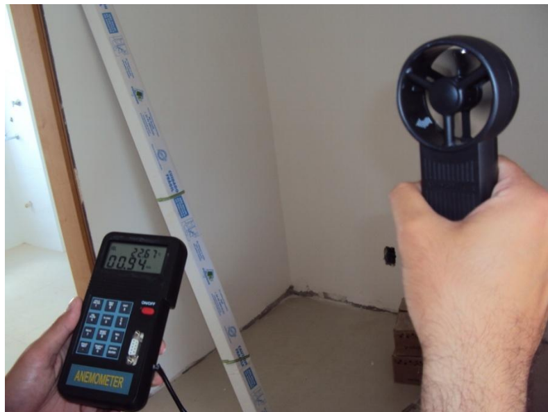
Figura 14 - Medição com Anemômetro Fonte: Autores, 2011.
