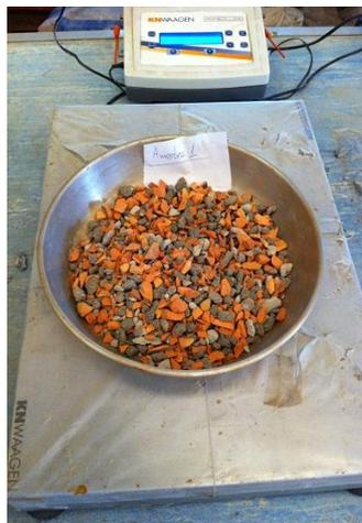
Figura 13 – Pesagem da amostra com o agregado seco em estufa
