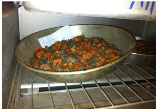
Figura 12 – Amostra na estufa com temperatura de 105 °C
