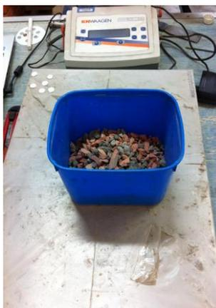
**Figura 9 – Pesagem de uma amostra com os RCD**
