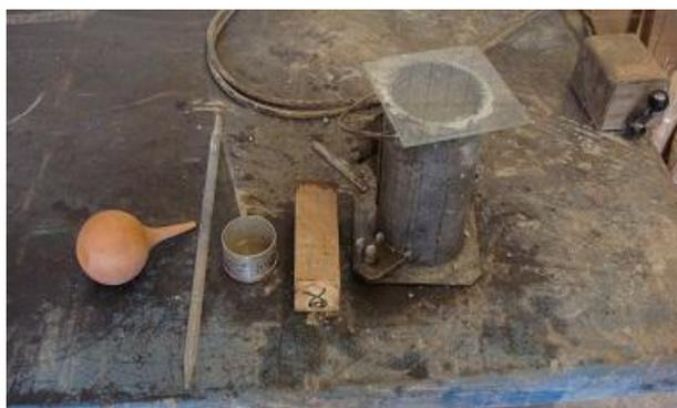
**Figura 25 – Materiais para o ensaio de Exsudação**
