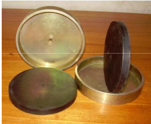
**Figura 8 – Base metálica utilizada com anel de retenção e almofadas de neoprene
