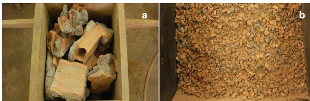
**Figura 7 – a) Resíduos oriundos de cortes de paredes. b) Resíduos após moagem**
