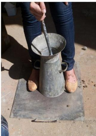
**Figura 19 – Processo do ensaio de Abatimento do Tronco de Cone**
