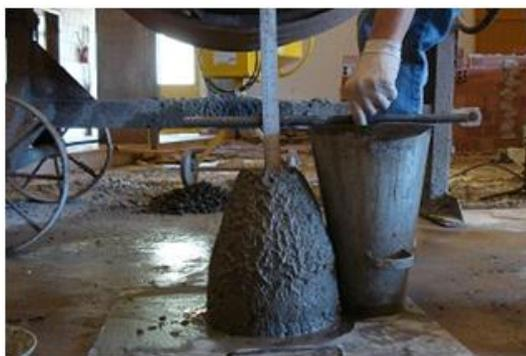
**Figura 20 – Abatimento Tronco de Cone – *Slump Test***
