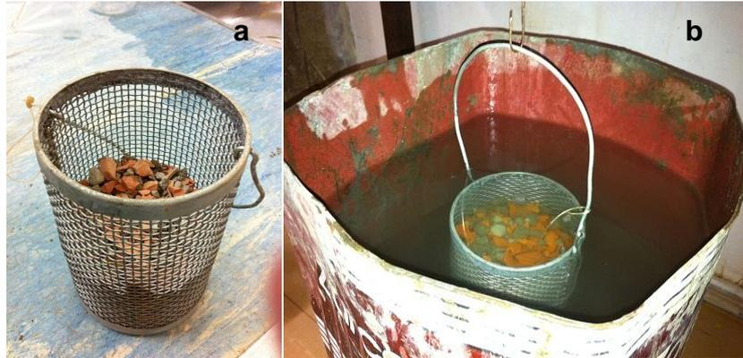
Figura 11 – a) Amostra no recipiente vazado. b) Amostra submersa em água
