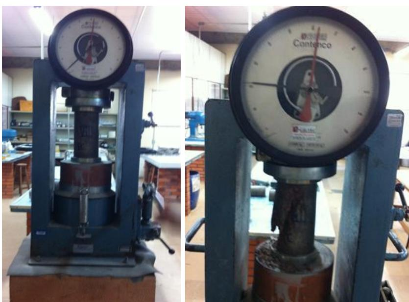
Figura 23 – Rompimento de um CP na prensa hidráulica
