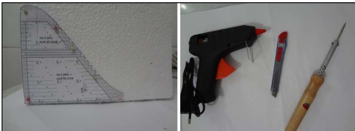
Figura 42 - Perfil para gabarito no isopor e ferramentas utilizadas. Fonte: As autoras (2013).
