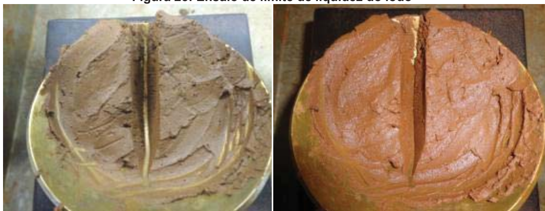
Figura 23: Ensaio de limite de liquidez do lodo
