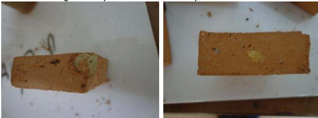
Figura 36: Impurezas encontradas nas pastilhas cerâmicas
