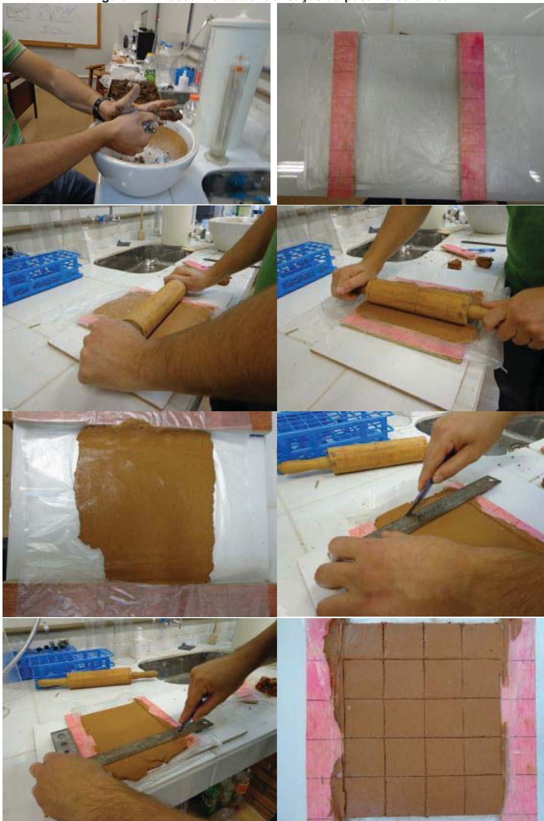
Figura 22: Procedimento de fabricação da pastilha cerâmica
