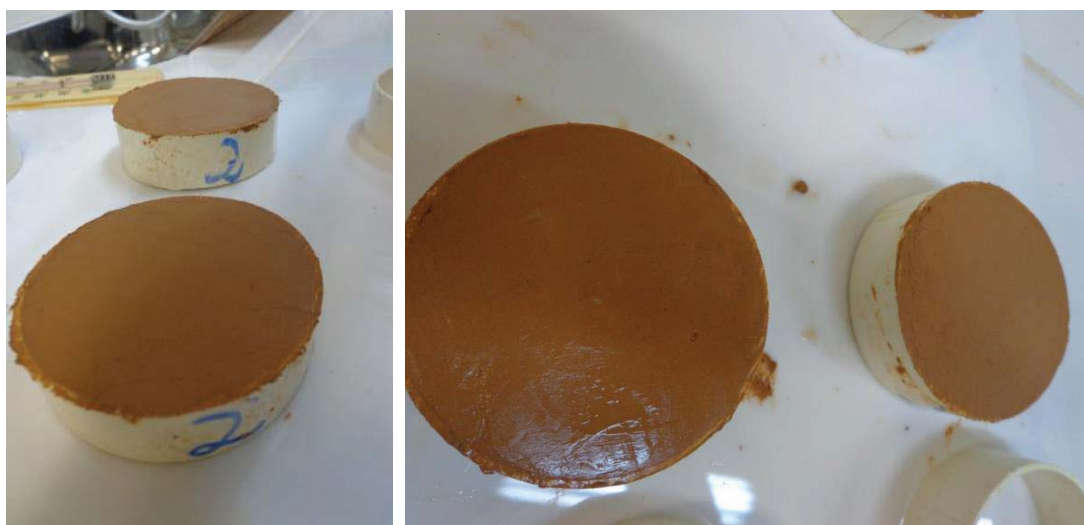
Figura 21: Amostras testes com 2 cm de espessura e molde I
