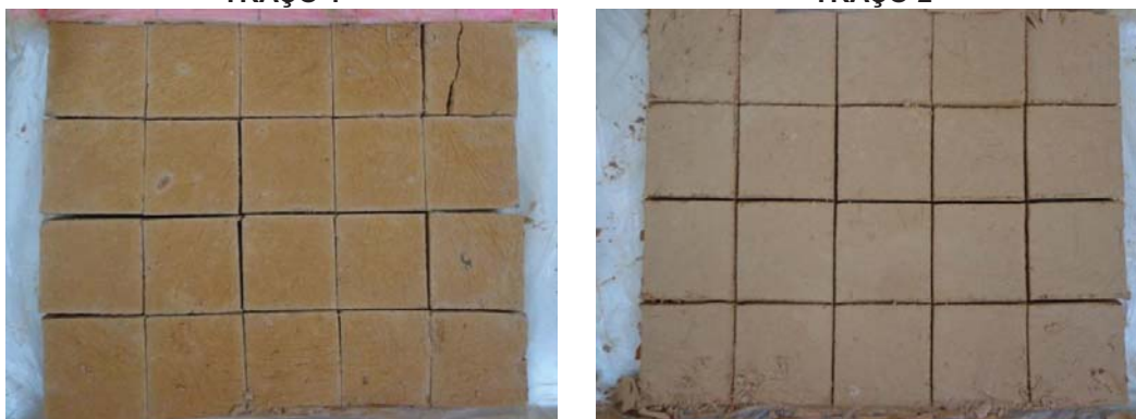
Figura 38: Amostras testes molde II espessura de 0,8 cm TRAÇO 1 TRAÇO 2
