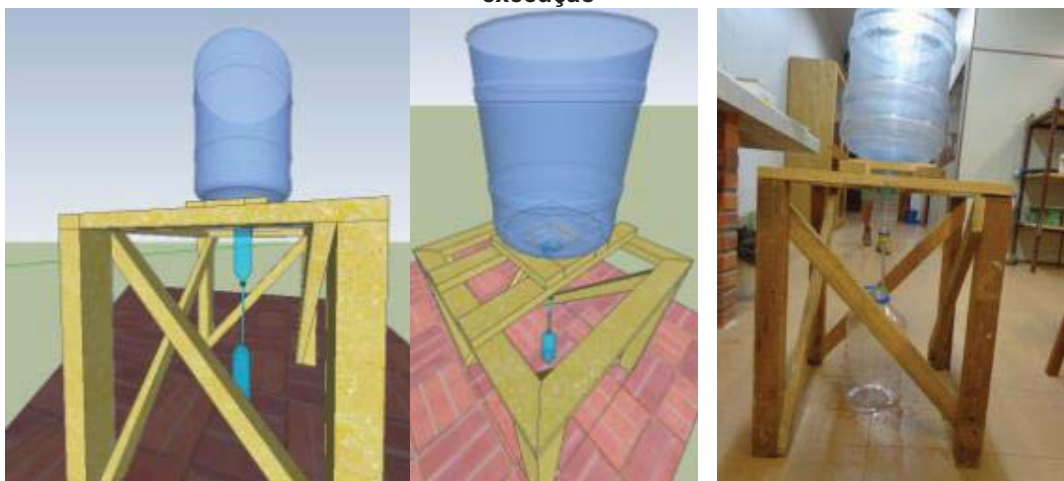
Figura 15: Posicionamento do tambor sobre o suporte e da garrafa pet 2,5 l – projeto e execução
