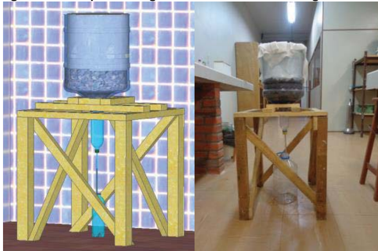
Figura 17: Perspectiva digital e real do filtro de secagem do lodo
