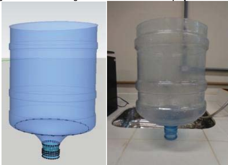
Figura 13: Tambor de água mineral sem o fundo – projeto e execução
