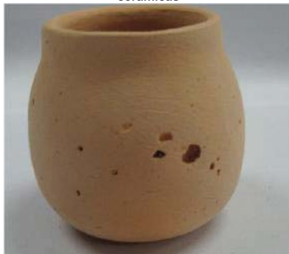
Figura 3: Furos e bolhas ocasionados pela utilização de lodo na confecção de peças cerâmicas
