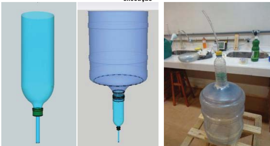
Figura 14: Fixação da mangueira, da garrafa e tela de plástico no tambor – projeto e execução
