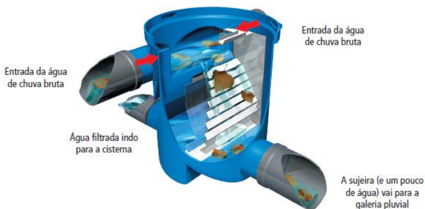
Figura 13 - Dispositivo de descarte de sólidos para áreas de captação de até 200m 2 Fonte: Acquasave (2013)
