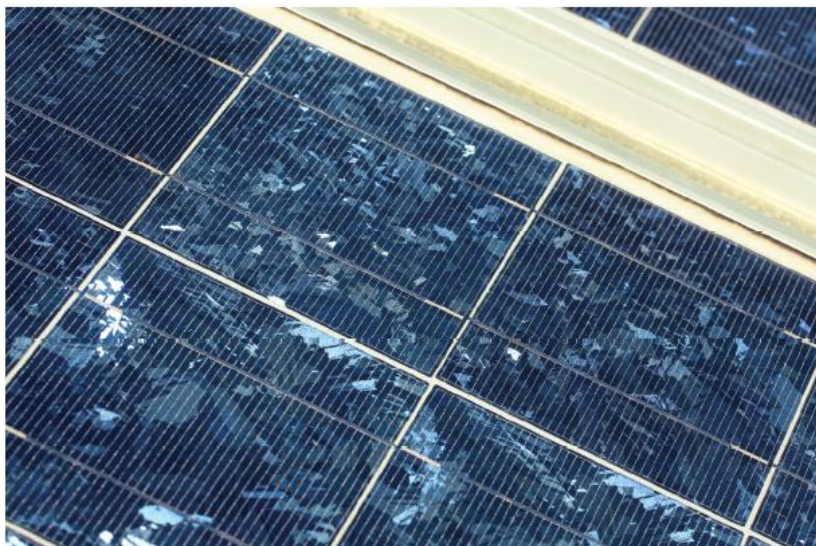
Figura 8 - Aspectos característicos de células de silício cristalino Fonte: LABEE, 2007a.
