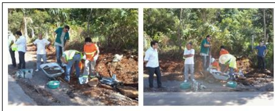
Figura 35: Moldagem dos corpos de prova. Fonte: Empresa X, 2013.
