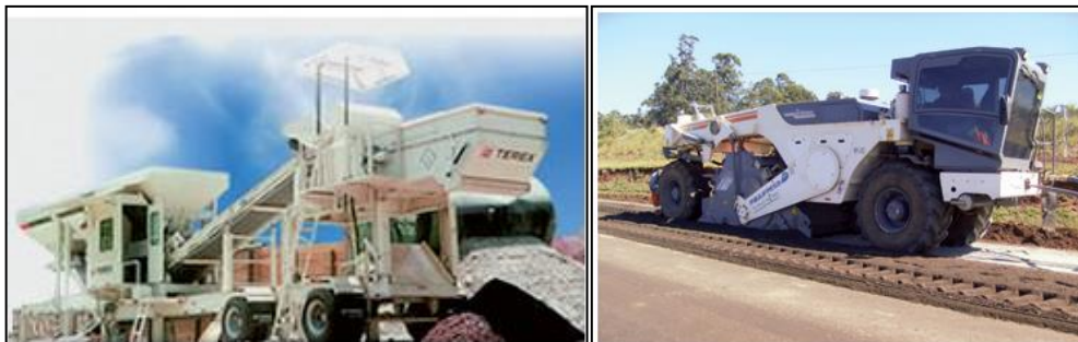
Figura 23: A esquerda usina móvel para misturas frias e a direita reciclagem a frio “ in situ ”
