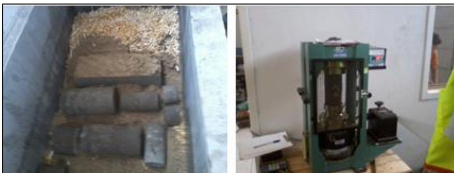
Figura 41: Cura e rompimento dos corpos de prova Fonte: Empresa X, 2013.
