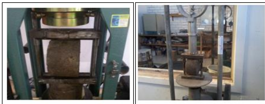
Figura 36: Rompimento dos corpos de prova Fonte: Empresa X, 2013.
