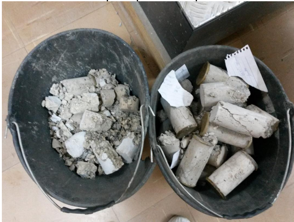
Figura 20 – Comparativo da integridade do concreto. À esquerda concreto que atingiu 800°C e a direita os corpos-de-prova com temperatura de até 500°C.
