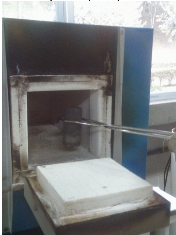
Figura 8 – Colocação de corpos-de-prova no forno mufla
