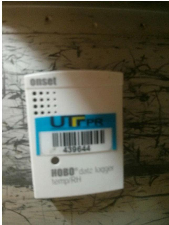
**FIGURA 24 - Data Logger de Temperatura**
