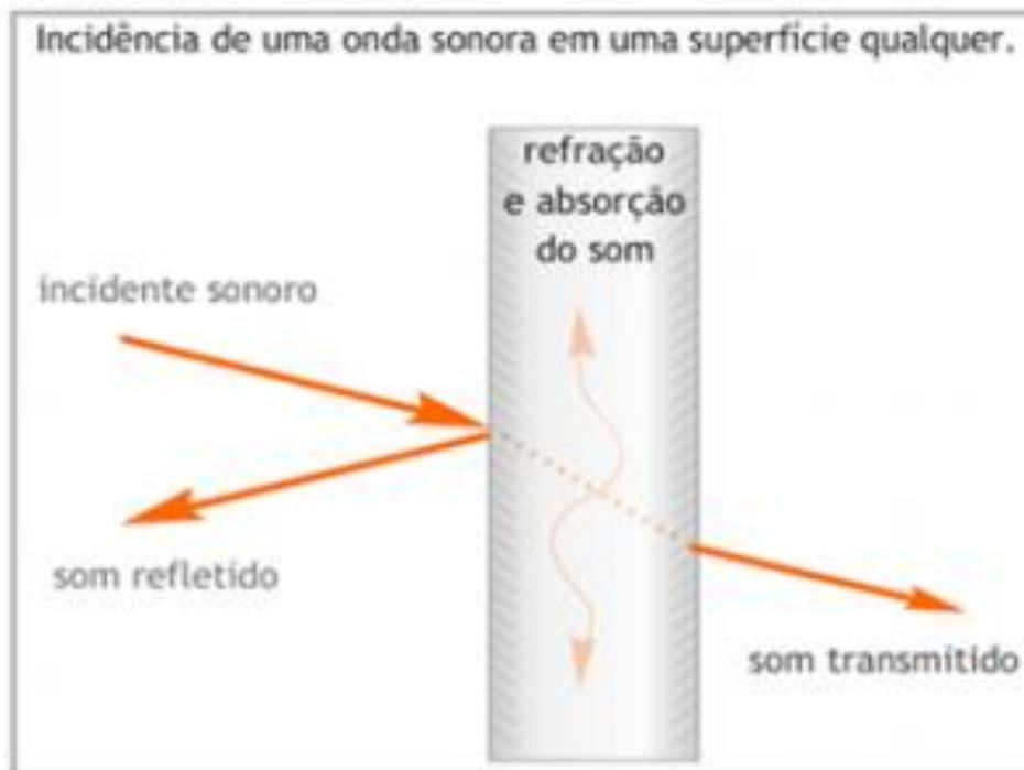
FIGURA 14 - Incidência de uma onda sonora em uma superfície qualquer
