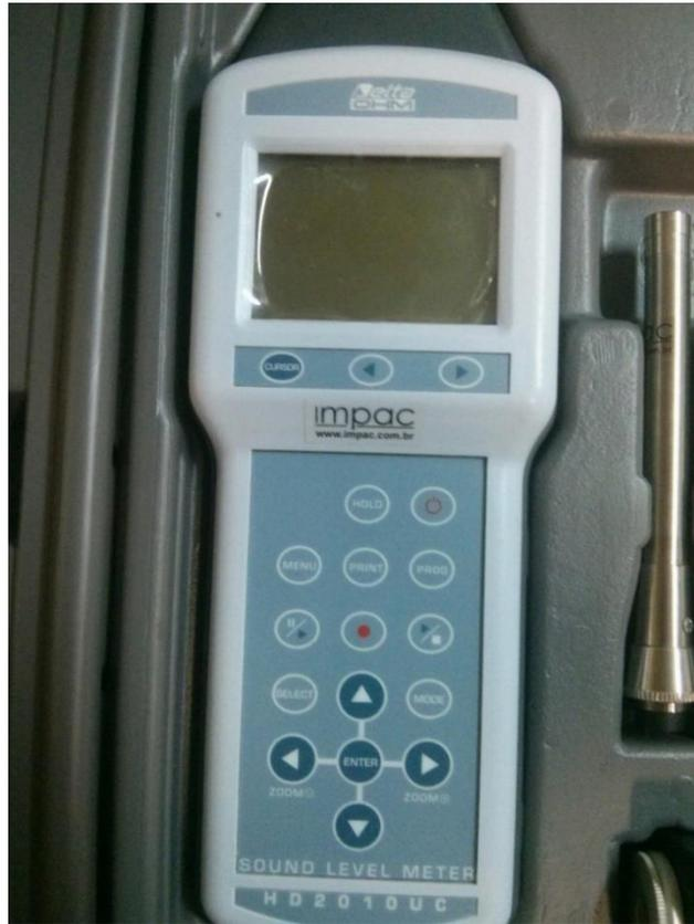
**FIGURA 21 - Medidor de intensidade sonora**
