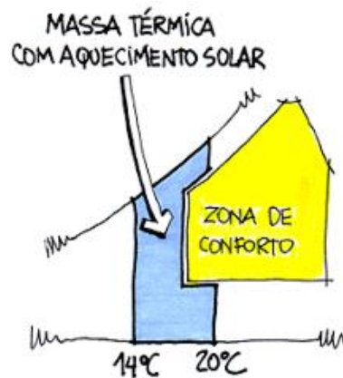
Figura 15 - Massa Térmica e Aquecimento Solar Fonte: LABCON, 2015.
