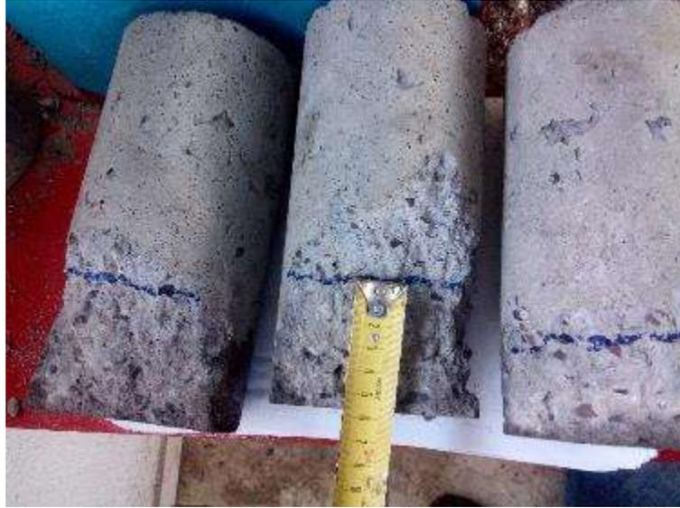
Figura 35 – Profundidade da absorção de água
