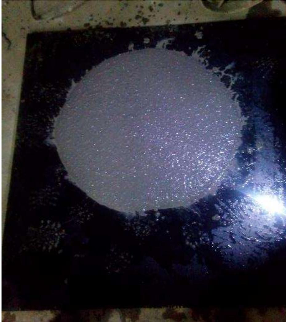
**Figura 31 – Aspecto do CAA submetido ao ensaio do espalhamento.
