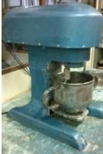
**Figura 21 – Argamassadeira Mecânica**
