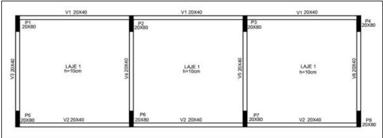
Figura 50 – Estrutura com quatro pavimentos, pilares com seções de 20x80 cm
