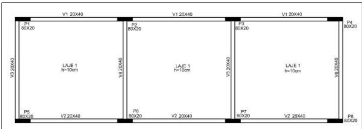
**Figura 45 - Estrutura com dois pavimentos, pilares com seções de 80x20 cm**
