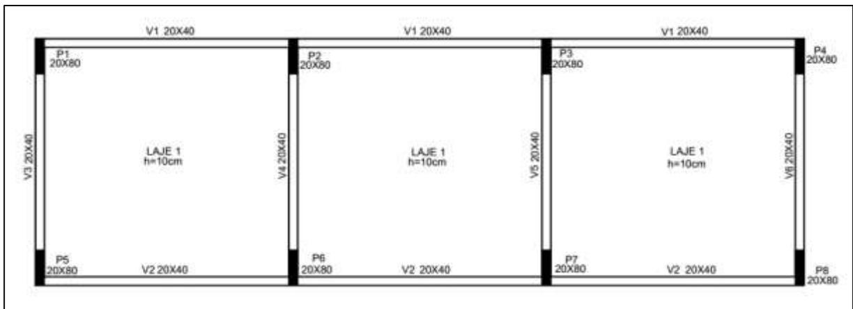
Figura 44 – Estrutura com dois pavimentos, pilares com seções de 20x80 cm
