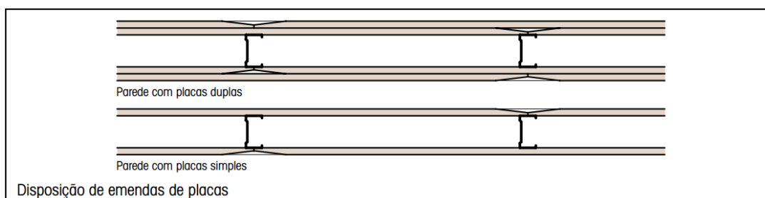
Figura 23 - Fechamento das paredes com placas de gesso Fonte: Placo (2013).
