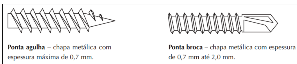
Figura 15 - Tipos de parafusos - ponta
