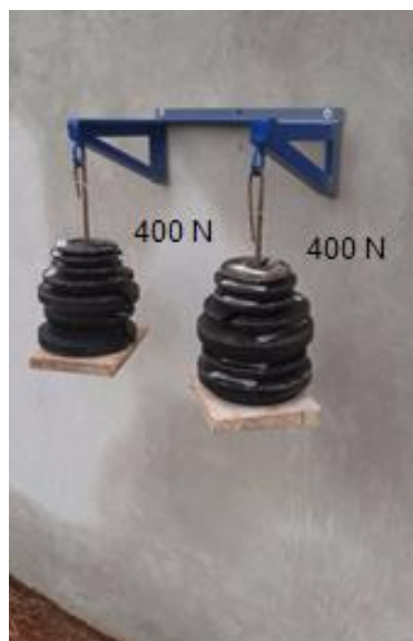
Figura 73: Mão francesa com todo o carregamento aplicado Fonte: O AUTOR, 2017.
