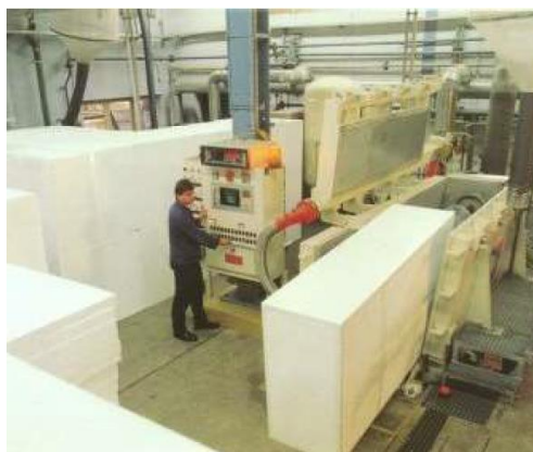
Figura 4: Bloqueira - moldagem do EPS Fonte: NETO apud ABRAPEX, 2006.
