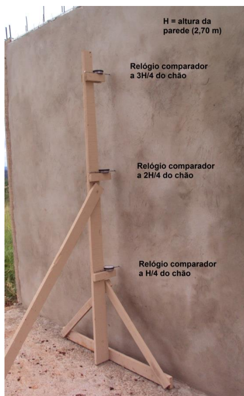
Figura 70: Distribuição dos três relógios comparadores Fonte: O AUTOR, 2017.
