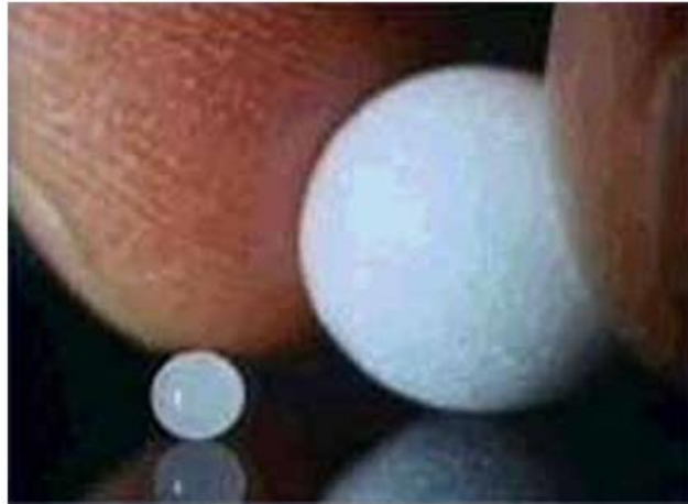
Figura 2: Pérola de poliestireno (antes da expansão) - granulado de EPS (após a expansão) Fonte: BERTOLDI apud ACEPE, 2006.
