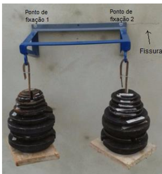
Figura 74: Ocorrência de fissura Fonte: O AUTOR, 2017.
