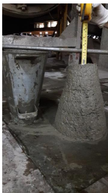
Figura 4 - Concreto fresco submetido ao ensaio de abatimento do tronco de cone Fonte: Autorial Própria
