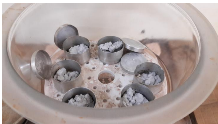
Figura 6 - Concreto endurecido submetido ao processo de dissecação Fonte: Autoria Própria
