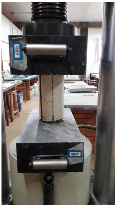
Figura 7 - Disposição vertical de um corpo de prova no ensaio de compressão simples Fonte: Autorial Própria
