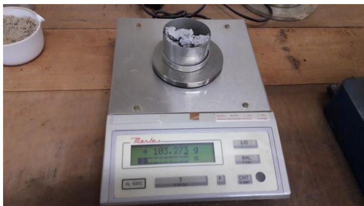
Figura 5 - Concreto fresco submetido à pesagem para o ensaio de umidade Fonte: Autoria Própria
