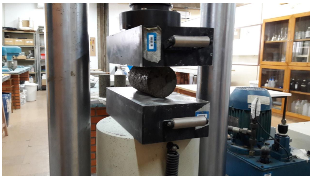
Figura 8 - Disposição horizontal de um corpo de prova no ensaio de tração por compressão diametral Fonte: Autoria Própria
