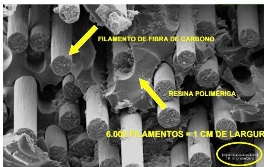
**Figura 8: Ampliação microscópica de um sistema CFC**
