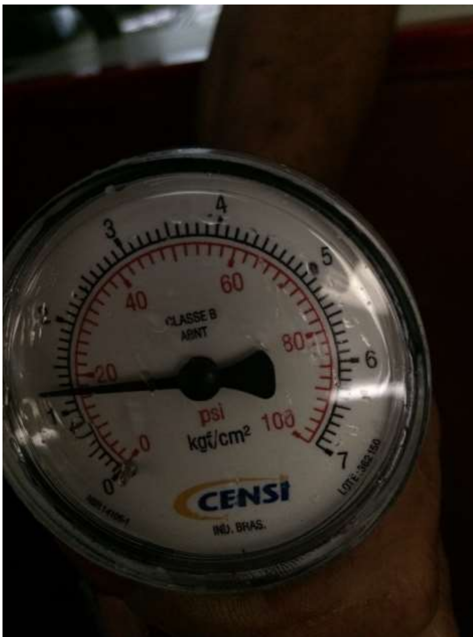
Foto 5: Valores do teste de vazão para o hidrante H-03. Fonte: Vasata, A. C. D. P. (2017).
