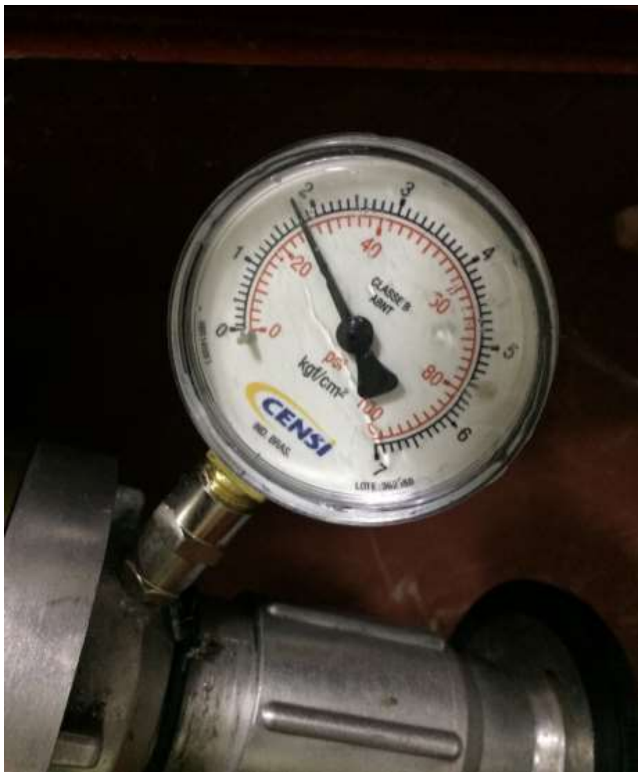
Foto 4: Valor do teste de vazão realizado no hidrante H-05. Fonte: Vasata, A. C. D. P. (2017).
