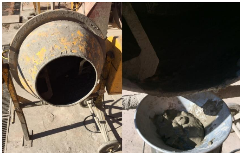
Figura 18 – Betoneira utilizada (à esquerda) e aparência do CPIV-0,5 fabricado (à direita) Fonte: Autoria própria (2017).
