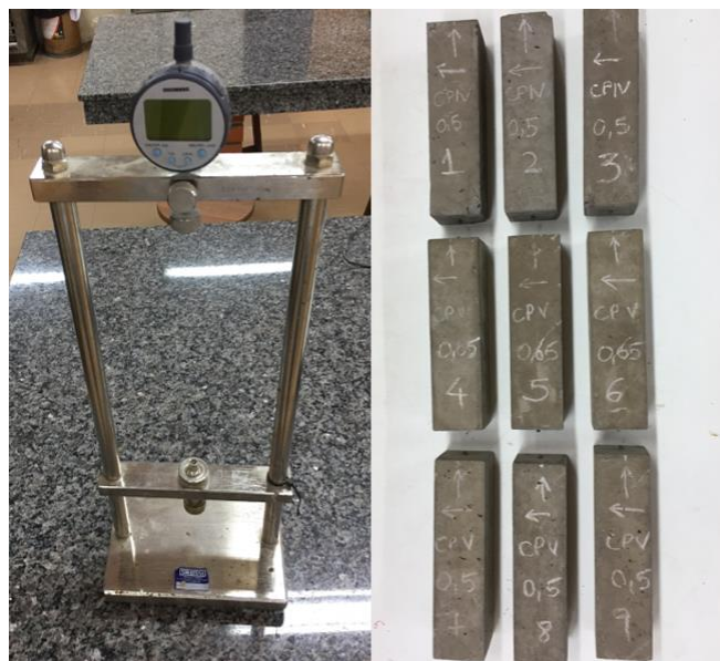
Figura 27 – Relógio comparador (esquerda) e amostras para variação dimensional e de massa (direita)
