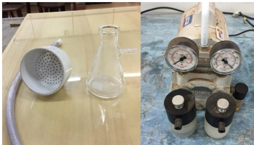
Figura 31 – Conjunto filtro de buncher e bomba de vácuo Fonte: Autorial própria (2017).
