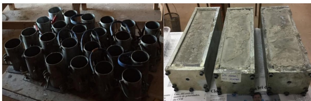
Figura 20 – Molde dos corpos de prova Fonte: Autoria própria (2017).
