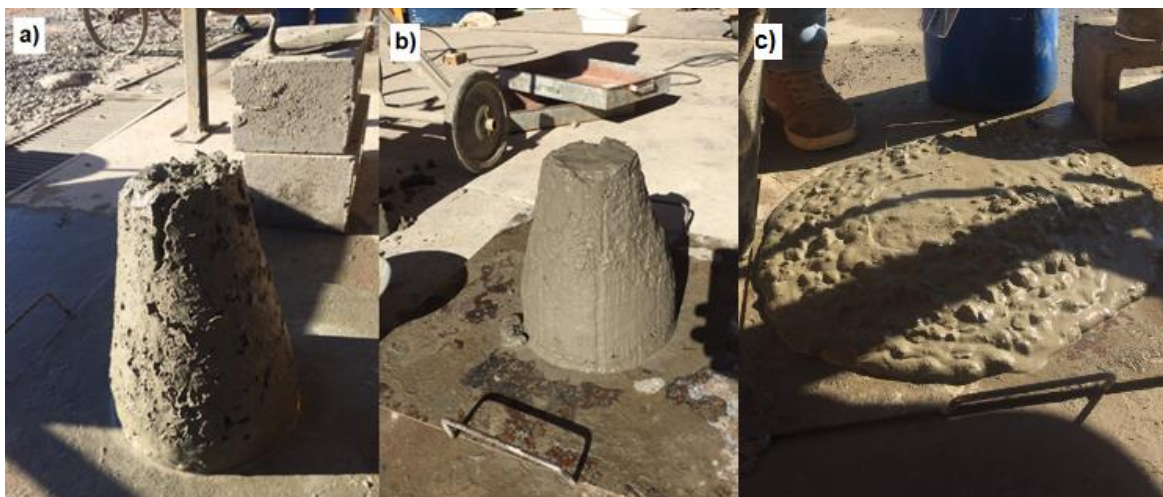
Figura 19 – Slump Test: a) CP V-0,5; b) CP IV-0,5; c) CP V-0,65 Fonte: Autoria própria (2018).
