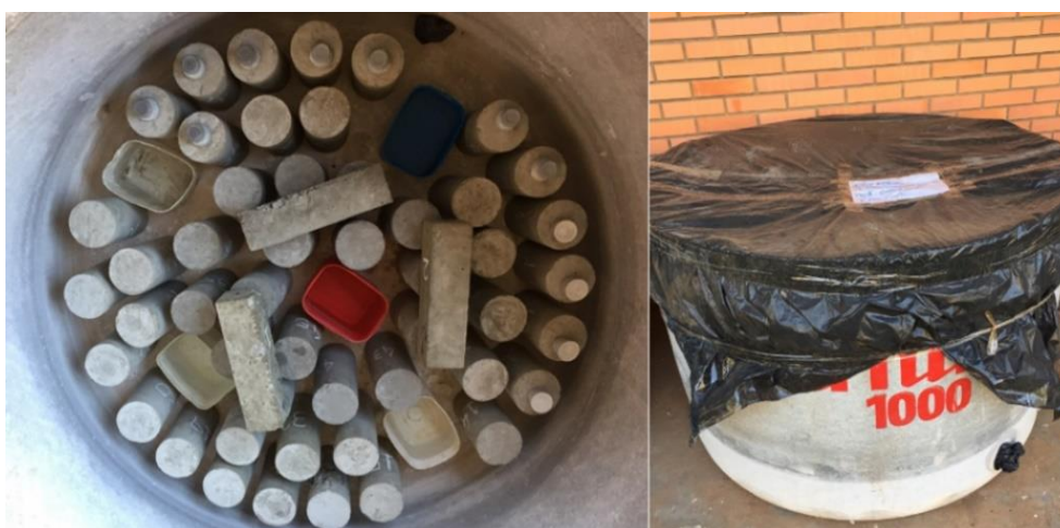
Figura 21 – Câmara úmida Fonte: Autoria própria (2017).
