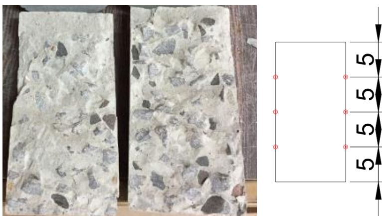
Figura 25 – Pontos utilizados para medição de profundidade de carbonatação Fonte: Autoria própria (2018).
