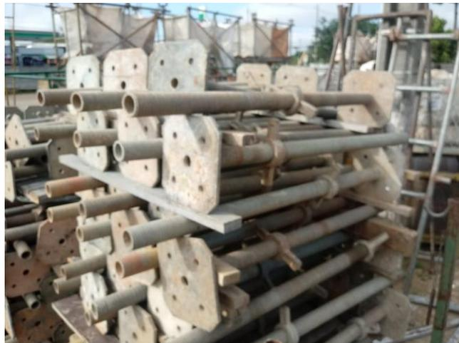
**Figura 22: Bases metálicas roscáveis**
