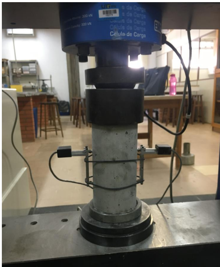
Figura 18: Ensaio de Módulo de Elasticidade Fonte: Autoria Própria (2016)
