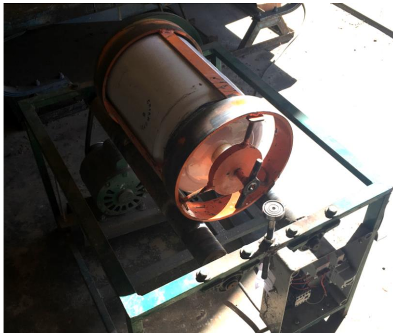
Figura 12: Moinho de bolas com temporizador Fonte: Autoria Própria (2016)
