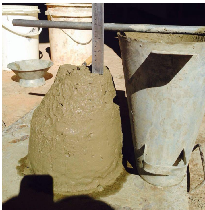
Figura 20: Abatimento do tronco de cone para 10% de fíler adicionado Fonte: Aatoria Própria (2016)
