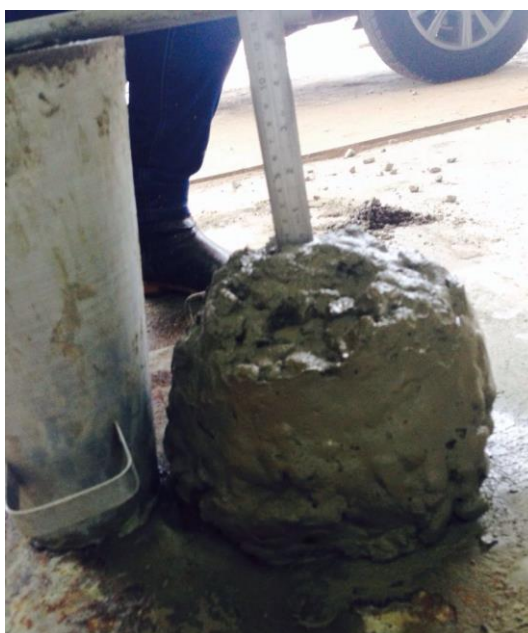
Figura 19: Abatimento do tronco de cone para 5% de fíler adicionado Fonte: Autorial Própria (2016)
