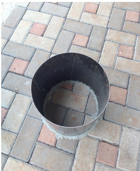
Figura 5 - Infiltrômetro de cilindro único usado para o teste de infiltração.
