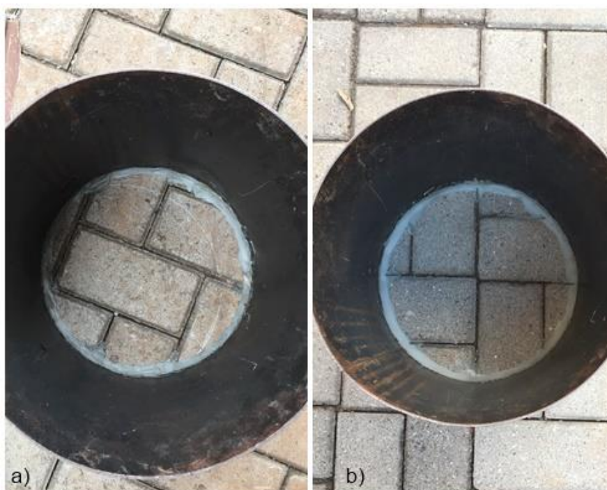
Figura 16 - a) arranjo geométrico tipo espinha de peixe; b) arranjo geométrico tipo trama
