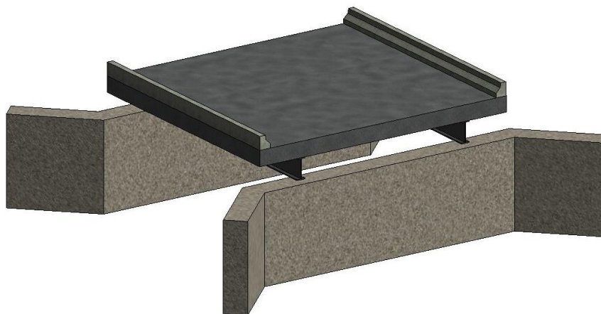
Figura 14 - Ponte mista aço/concreto Fonte: Autores (2017).
