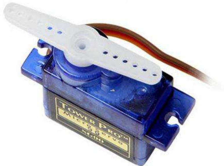
**Figura 5 – Servo motor SG90**
