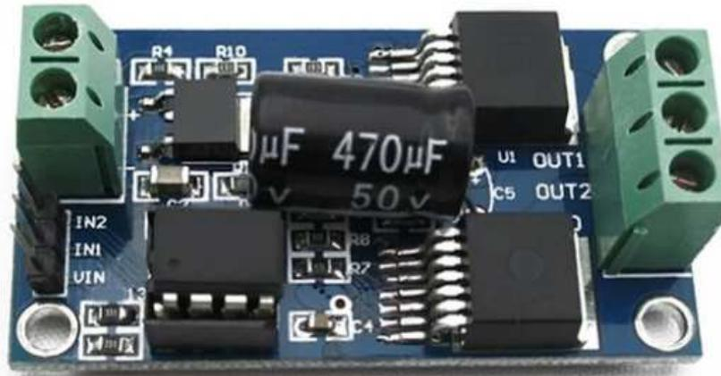
**Figura 12 – Módulo de acionamento BTN7970**
