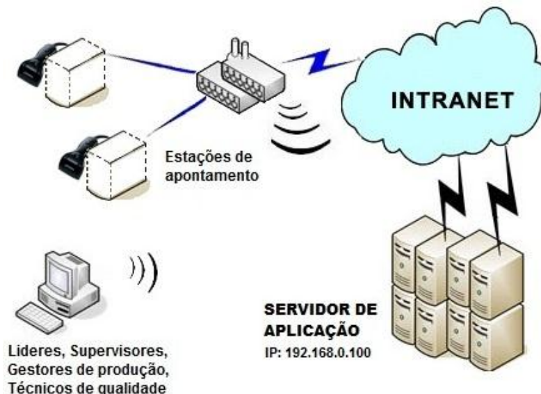
Figura 18: Diagrama da rede intranet adotada no ambiente de teste.
