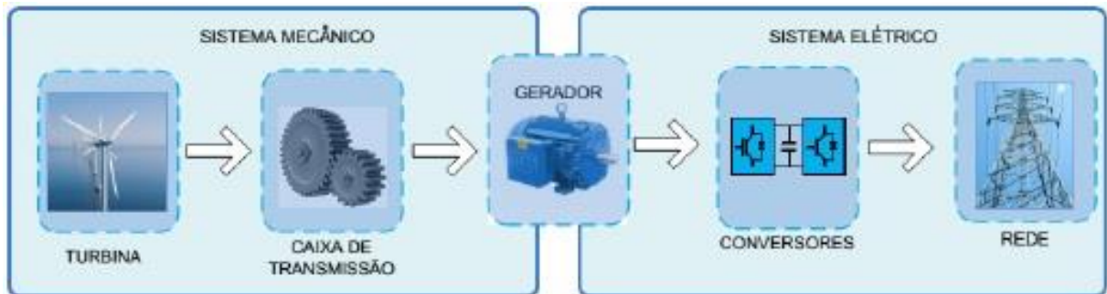
Figura 6 - Diagrama ilustrativo de um sistema eólico conectado à rede.
