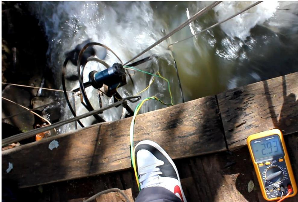
Figura 26 – Máxima tensão no teste na saída turbina para o ensaio 3.
