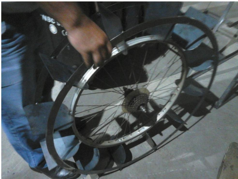
**Figura 14 – Anel de fixação das pás**
