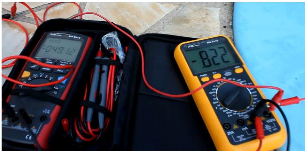
**Figura 22 – Máxima tensão e corrente com carga resistiva.**
