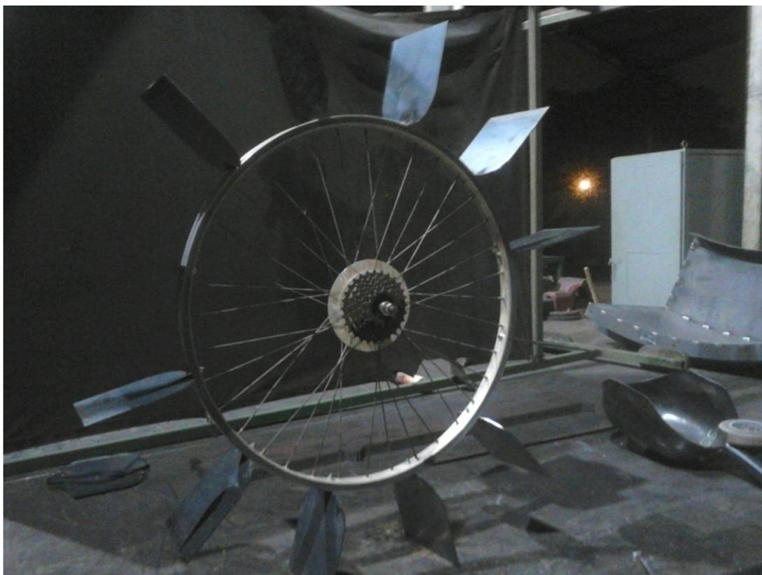
**Figura 13 – Rotor e pás na turbina hidrocínética.**
