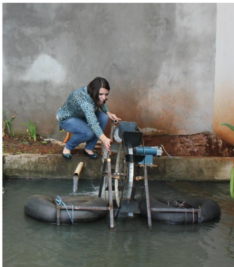
**Figura 19 – Turbina acionada por água em rio artificial.**
