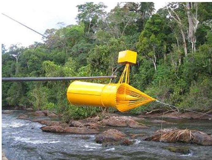
**Figura 3 – Turbina hidrocínética tipo “eólica”**
