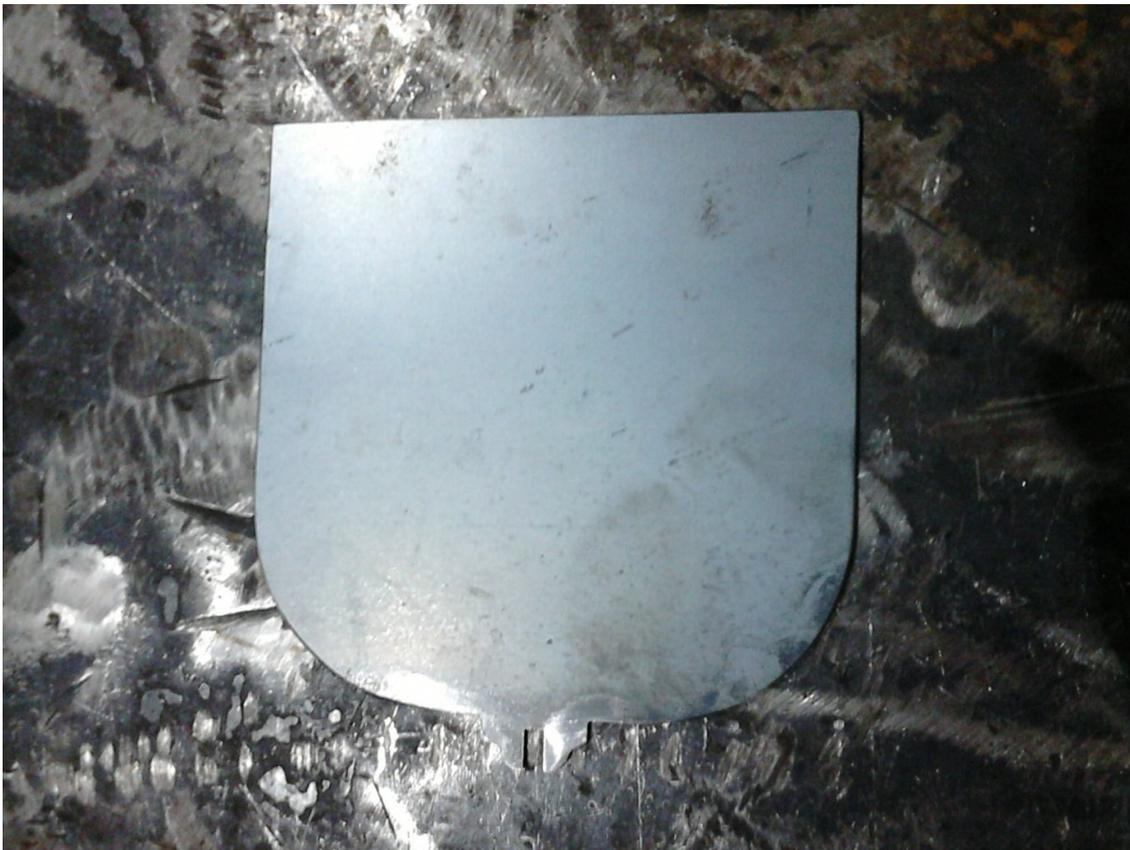
**Figura 11 – Pás da turbina hidrocínética**
