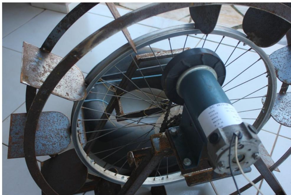
Figura 17 – Gerador acoplado a turbina, formando a micro usina proposta.
