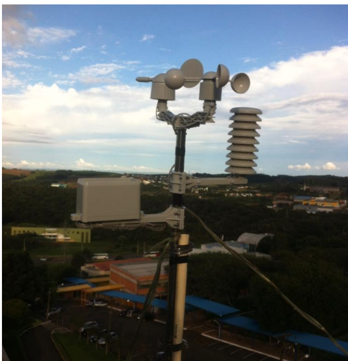
Figura 9 – Estação Meteorológica Instalada na UTFPR Fonte: Autoria própria.
