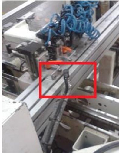
Figura 11 - Sensor capacitivo para registro de produção Fonte: Autoria Própria
