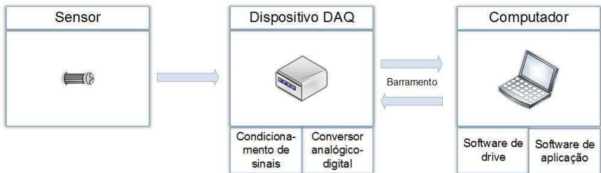
Figura 1: Diagrama utilizado para a aquisição de dados. Fonte: Adaptado de (NATIONAL INSTRUMENTS, 2015).
