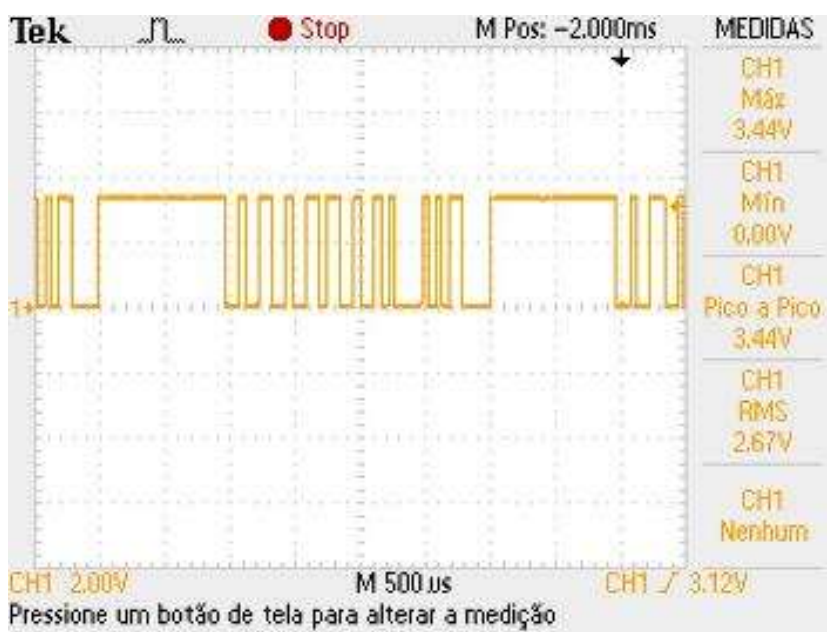
Figura 83 - Forma de onda de dados na saída do microcontrolador da unidade sensora utilizando uma taxa de transferência de dados de 19200 bits/s .
