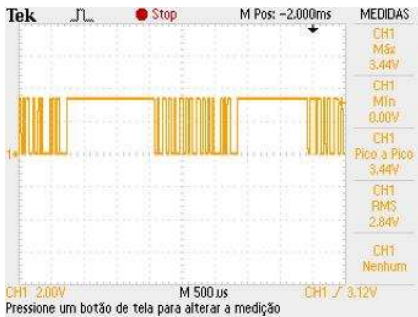
Figura 89 - Forma de onda de dados na saída do microcontrolador da unidade sensora utilizando uma taxa de transferência de dados de 38400 bits/s.
