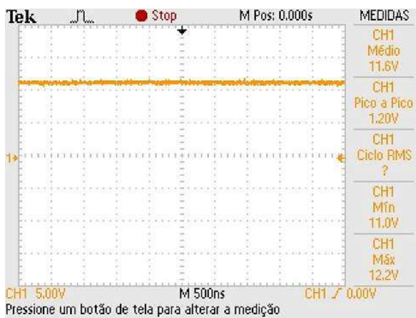
Figura 33 - Forma de onda obtida ap&oslash;s o circuito de retifica&ccedil;o da unidade sensora na avalia&ccedil;o pr&atilde;tica do sistema de alimenta&ccedil;o. Fonte: Autoria pr&oslash;pria.
