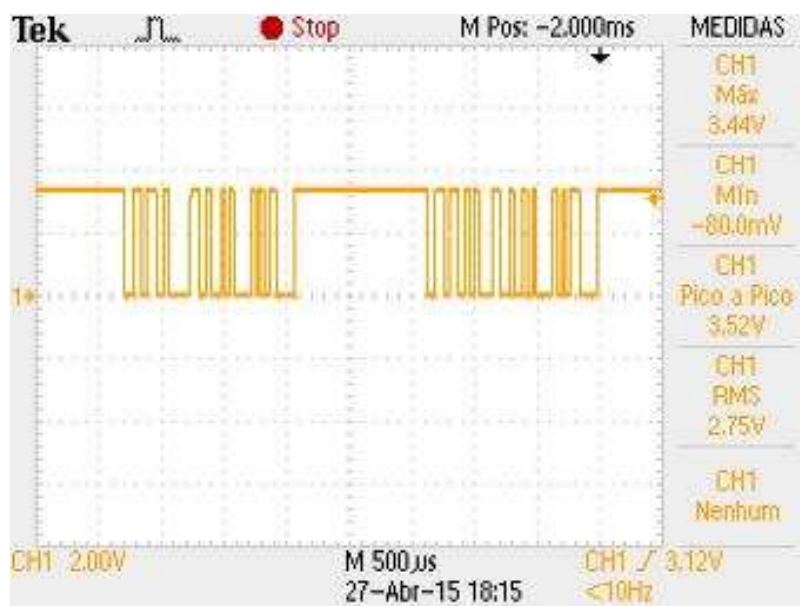
Figura 86 - Forma de onda de dados na saída do microcontrolador da unidade sensora utilizando uma taxa de transferência de dados de 28800 bits/s.
