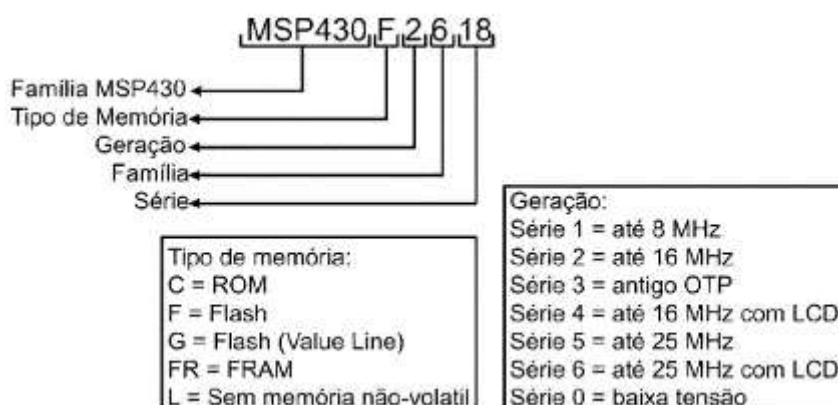
Figura 14 - Identificação dos microcontroladores da família MSP430 Fonte: Extraído de Silva (2013).
