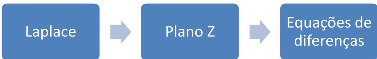
Figura 35 - Diagrama de blocos método de discretização.
