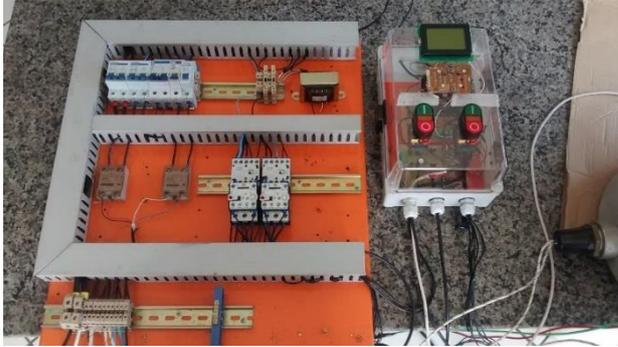
**Figura 44 – Dispositivos de potência e painel com display gráfico e botões para parametrização.**
