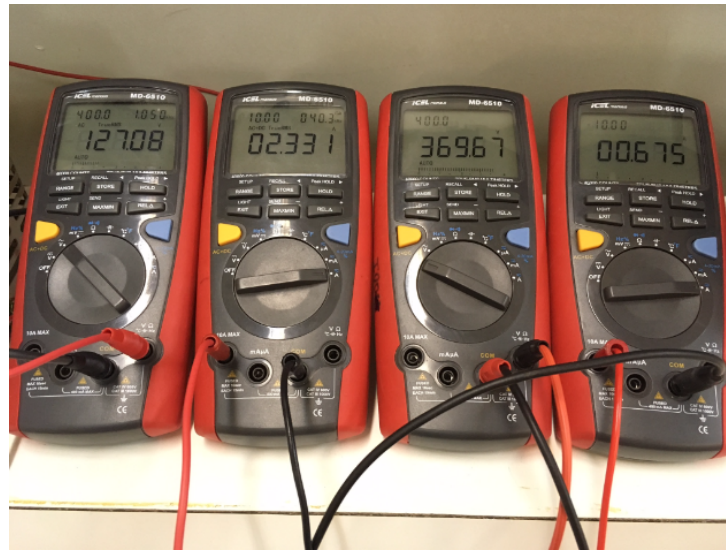
Figura 40: Medidas do Retificador Controlado para Tensão de Entrada de 127V
