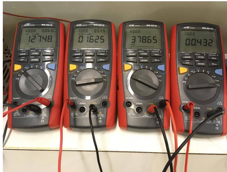
Figura 35: Medidas do Retificador Não Controlado para Tensão de Entrada de 127V
