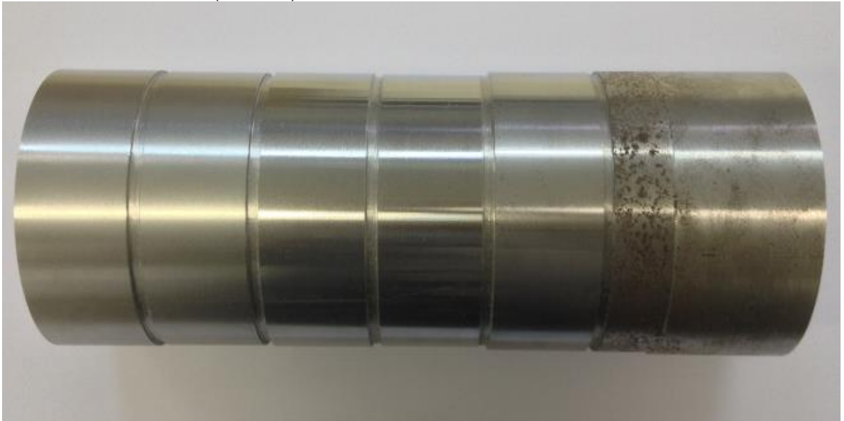
Figura 17 – Corpo de prova utilizado nos experimentos após usinagem com a ferramenta convencional ( standard )
