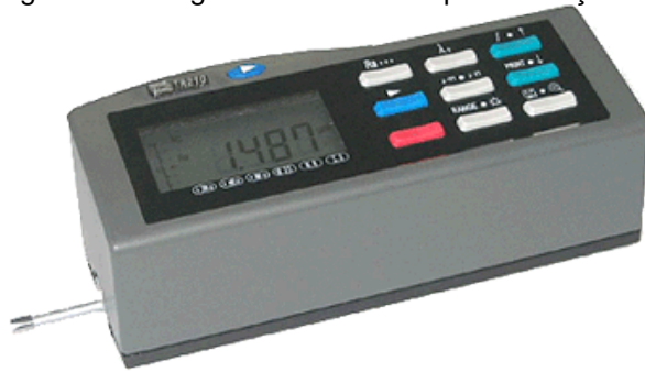
Figura 10 – Rugosímetro utilizado para medição da rugosidade nos ensaios de usinagem
