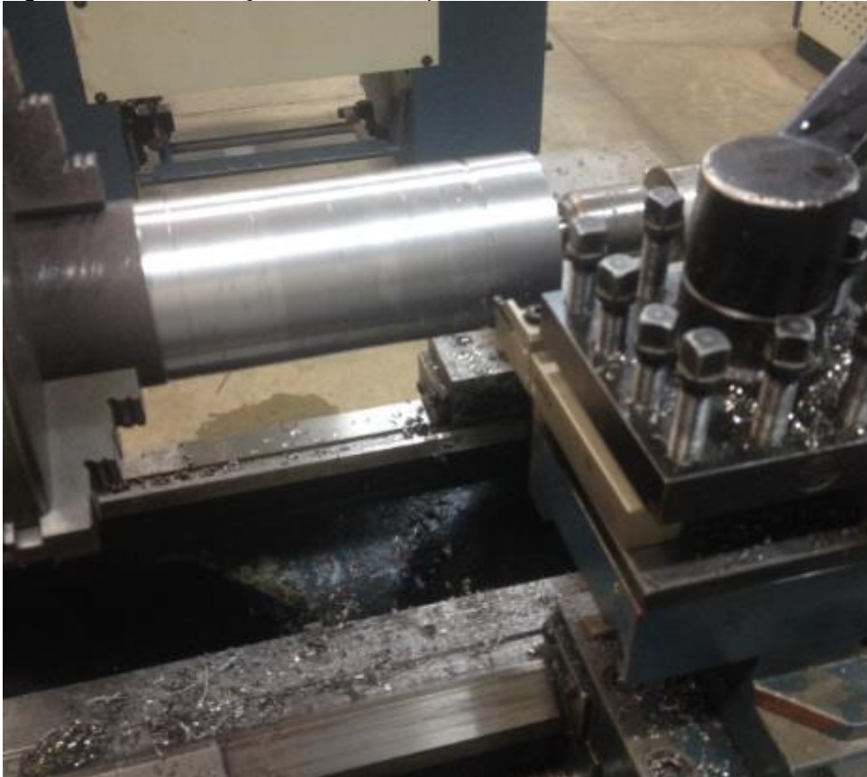
Figura 16 – Barra de aço AISI 8640 acoplada ao torno
