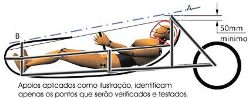
Figura 8 – Pontos obrigatórios da estrutura do chassi Fonte: Regulamento Maratona brasileira de eficiência energética 2015
