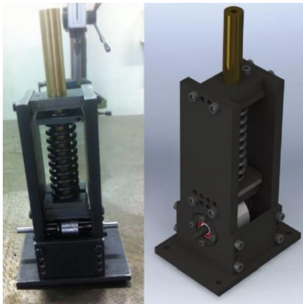
Figura 6: Excitador do tipo mecanismo came-seguidor. Fonte: Zardo F.; Daros R. (2013).
