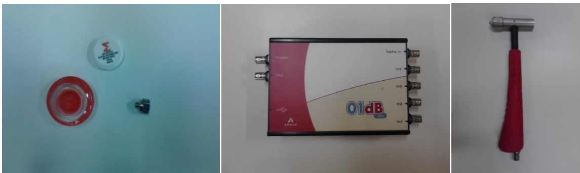
Figura 15: Acelerômetro, analisador de vibrações e martelo de impacto. Fonte: Autor.
