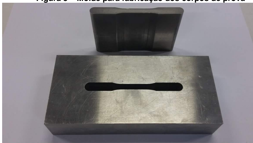
Figura 3 – Molde para fabricação dos corpos de prova
