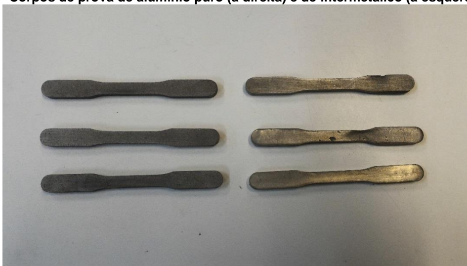
Figura 4 – Corpos de prova de alumínio puro (à direita) e de intermetálico (à esquerda)
