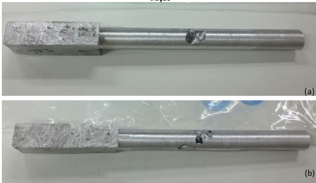
Figura 07 – Corpos de prova (a) 05 e (b) 06 obtidos sem vibração excluídos dos ensaios de tração
