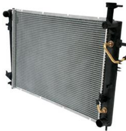
Figura 4 – Trocador de calor compacto – radiador automotivo.
