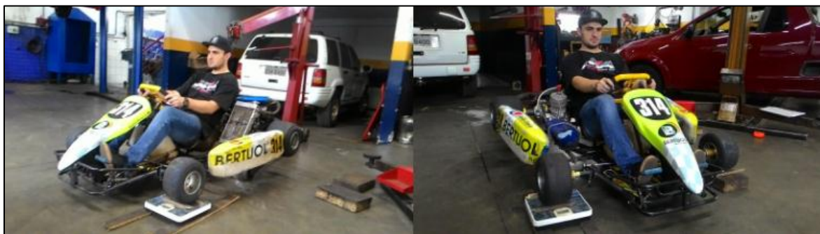
Figura 30 – Medida da massa do eixo dianteiro em plano inclinado (kart 1)
