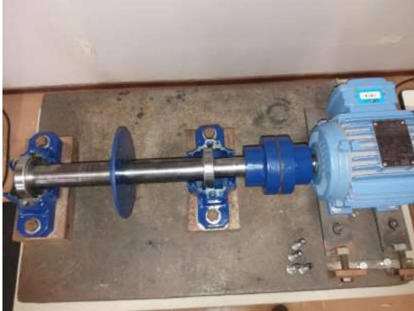
Figura 22 - Posicionamento das caixas de rolamento
