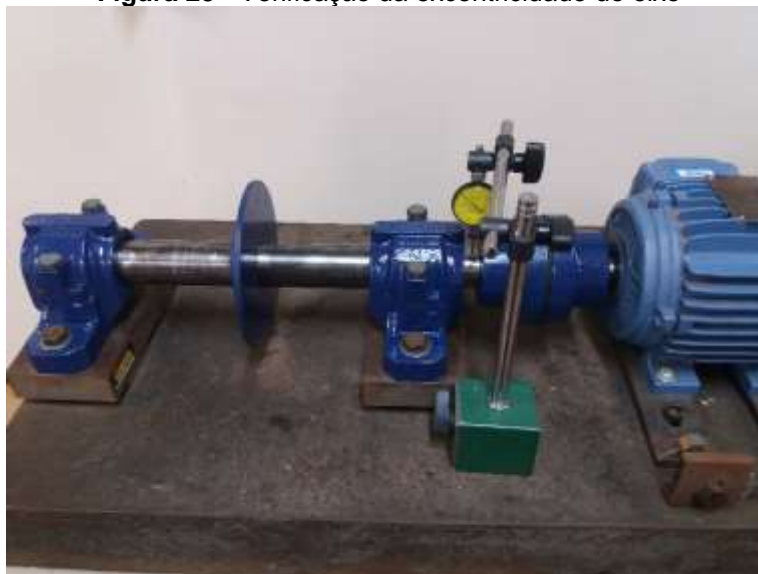
Figura 23 - Verificação da excentricidade do eixo
