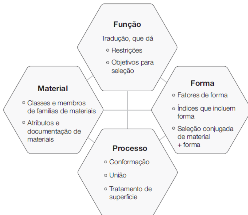
Figura 15 - Seleção de processos depende do material e forma
