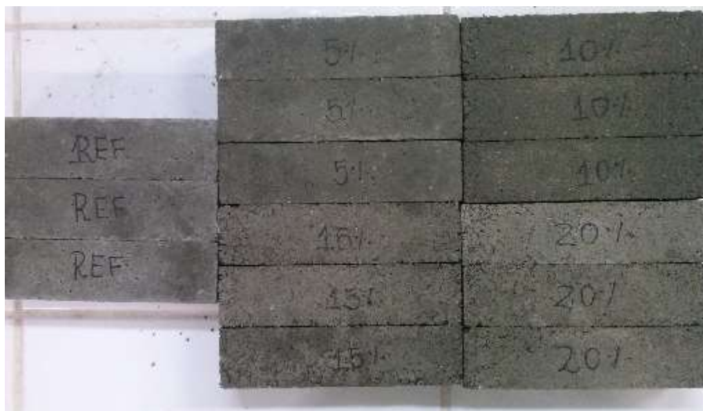
Figura 6 – Corpos de prova desmoldados após 24 horas.
