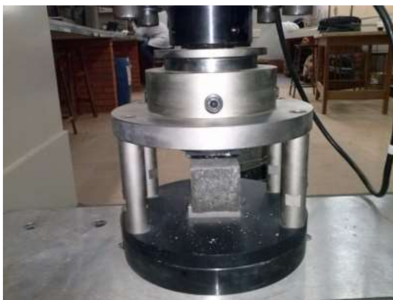
Figura 8 – Ensaio de resistência à compressão dos corpos de prova.
