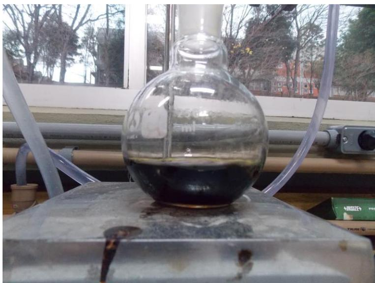
**Figura 4** – Sistema com condensador para síntese dos ésteres.
