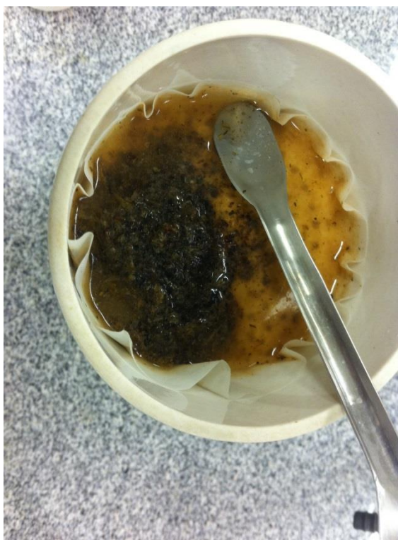
Figura 7 – Processo de digestão ácido-álcali para obtenção de Quitina. Fonte: Autoria Própria.
