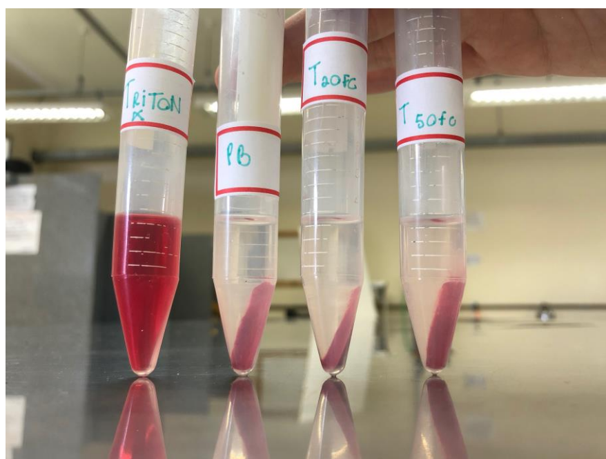
Figura 22: Atividade hemolítica dos substratos incorporados com fármaco CS e colágeno. Fonte: Autor
